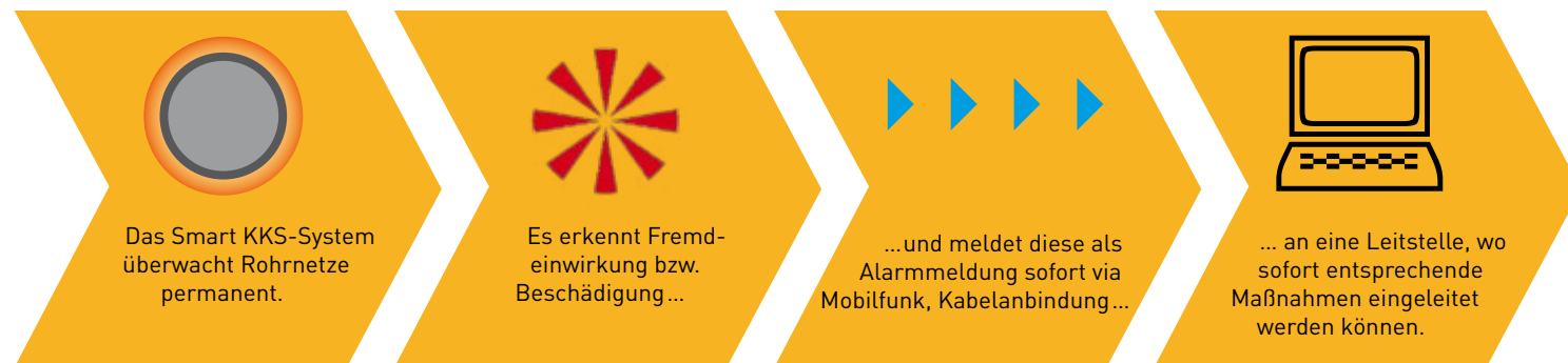
Funktionsprinzip des Smart KKS-Systems
