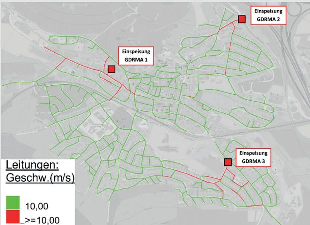
**Bild 3:** Überhöhte Strömungsgeschwindigkeiten im Niederdruck-Gasrohrnetz bei der Verwendung von Wasserstoff als Brenngas (Beispiel)
